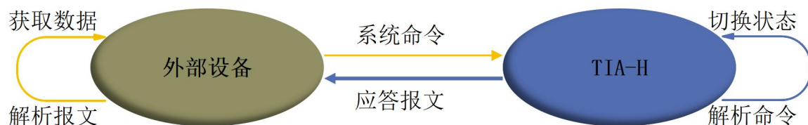
图 1 YDLIDAR TIA-H 系统通信机制
