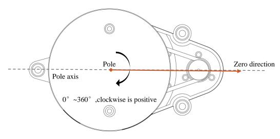
FIG 4 YDLIDAR X2 POLAR COORDINATE SYSTEM DEFINITION
