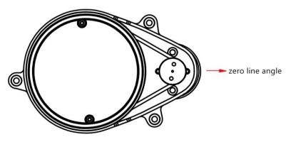
FIG 3 YDLIDAR X4PRO POLAR COORDINATE SYSTEM DEFINITION
